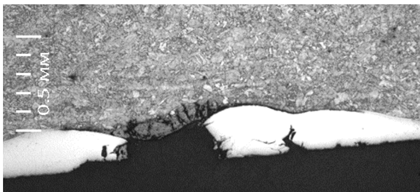
Рисунок 2 – Микроструктура поверхностного слоя горячекатаной стали типа 12ХН2МД с напылением алюминиевого покрытия после термообработки
