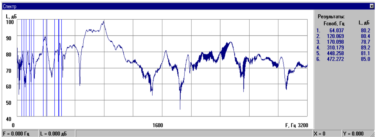
Рисунок 3.5 – Спектр собственных частот станины
