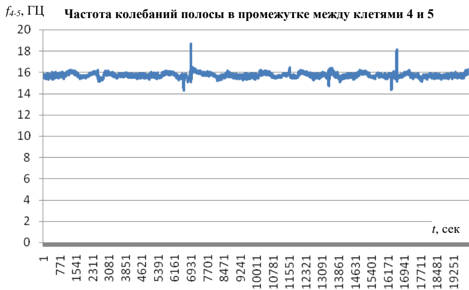
Рисунок 3.27 – Диаграммы колебаний стальной полосы в различных режимах работы стана при прокатке толстого сортамента
