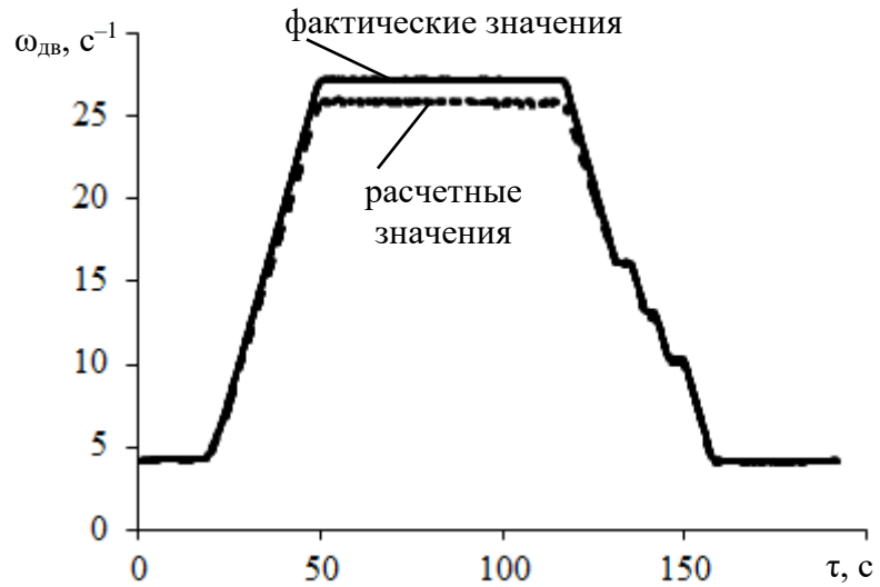
Рисунок 2.27 – Графики изменения угловой скорости вращения вала электродвигателя
