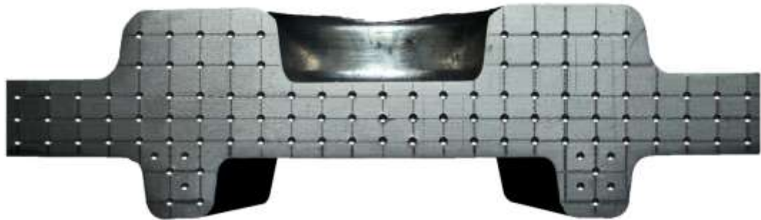
Рисунок 3.18 – Поковка «фланец» после замера твердости
