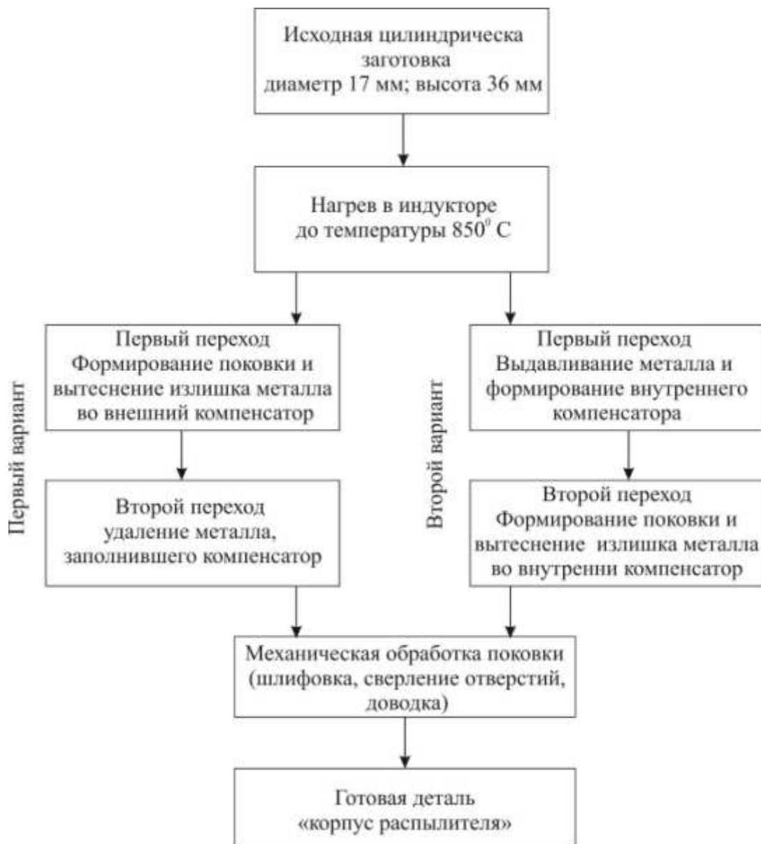
Рисунок 5.12 – Последовательность технологических операций при штамповке детали «корпус распылителя»
