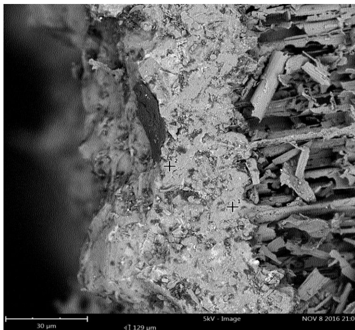
Рис. 4.20. Снимок микроструктуры пленки диоксида кремния, образованной на УУКМ в процессе испытания на окислительную стойкость: 1, 2 – точки, в которых исследован элементный состав пленки \text{SiO}_2
