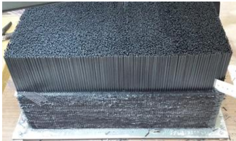
Рис. 3.4. Каркас из углеродных стержней со схемой армирования 4D-L в процессе сборки
