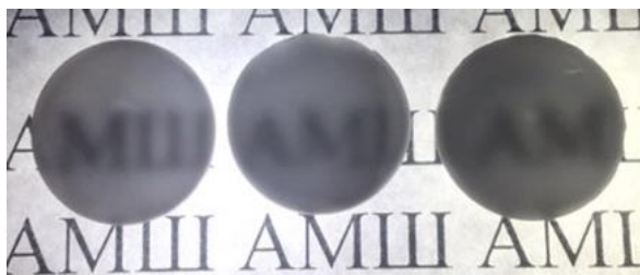
Рисунок 58 – Фотография образцов после вакуумного обжига при 1750 °С. Концентрации добавки слева на право – 9,6; 10,5; 11,5 мол. %.
