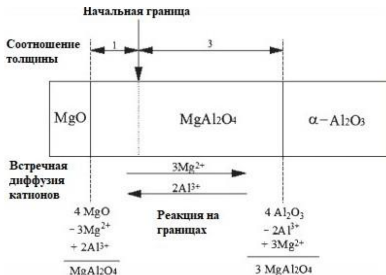
Рисунок 13 – Механизм Вагнера образования алюмомагниевого шпинели [17].
