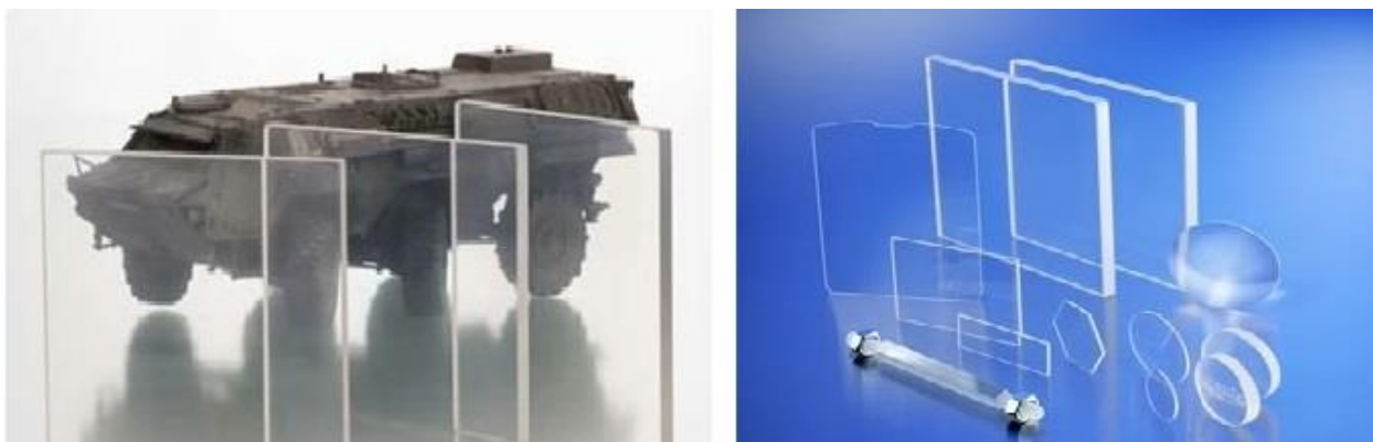
Рисунок 2 – Прозрачная керамика PERLUCOR [6].
