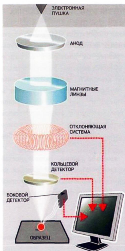
Рисунок 35 – Принципиальная схема растрового сканирующего микроскопа.
